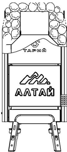
**Рисунок 4. Укладка камней**
